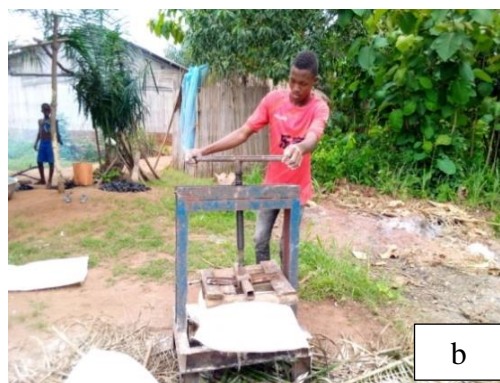
Photo b : Vue partielle d'un pressage mécanique du manioc à Hekanmè centre
