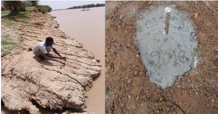
Photo 1 : Mise en place des stations de mire pour le suivi de l'érosion fluviale à Fondé Élimane, Cliché GUEYE A. août 2016
